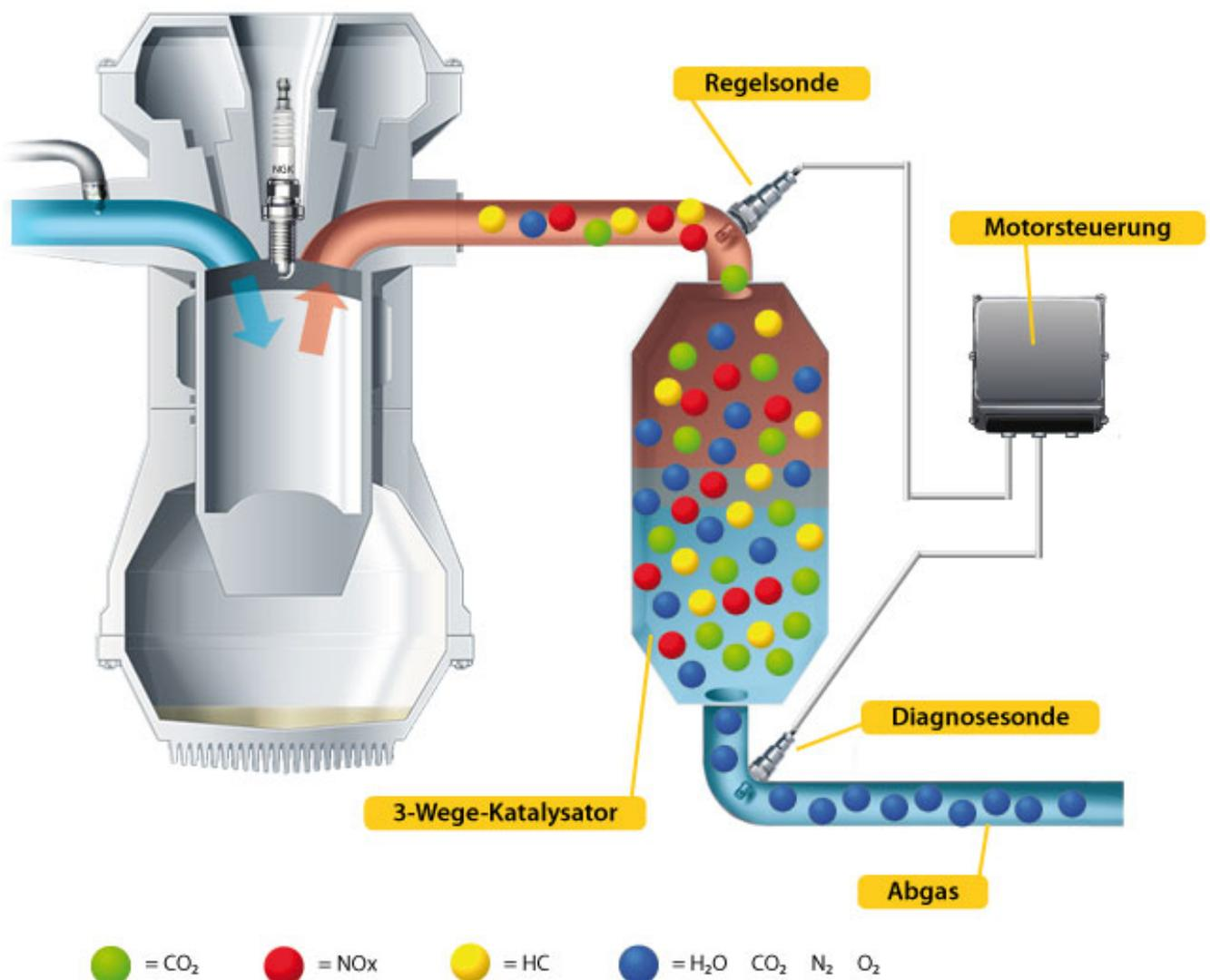
Die Lambdasonde misst den Restsauerstoffgehalt des Abgases und leitet den Wert in Form einer elektrischen Spannung an das Motorsteuergerät. Anhand der Lambdasonden-Spannung erkennt das Steuergerät die Gemisch-Zusammensetzung (mager oder fett). Ist das Gemisch fett, reduziert das Steuergerät die Kraftstoffmenge im Mischungsverhältnis. Bei einem mageren Gemisch erhöht es die Kraftstoffmenge im Mischungsverhältnis.
