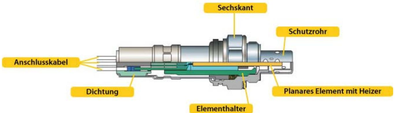
Um früher in die Abgasregelung eingreifen zu können, müssen Lambdasonden schneller auf Betriebstemperatur kommen. Das gewährleisten beheizte Lambdasonden, die heutzutage eingesetzt werden. Diese müssen nicht unbedingt in der Nähe des Motors eingebaut werden.
