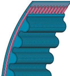
bewegte Masse aus. Dadurch wird der Benzinverbrauch sowie der CO<sub>2</sub>-Ausstoß positiv beeinflusst. Des Weiteren erfordern Zahnriementriebe konstruktiv einen deutlich geringeren Aufwand bezüglich der vorderen Motorenabdichtung gegenüber Konzepten mit Steuerketten oder Stirnrädern. Dadurch können bei der Motorenentwicklung und auch bei der Produktion Ressourcen eingespart und die Umwelt geschont werden.
