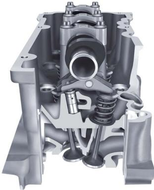
Auslassventile öffnen und schließen den Auslass für die Abgase. Die Ventile werden über die Nockenwelle betätigt. Sie wird über den Zahnriemen von der Kurbelwelle angetrieben und öffnet und schließt kurbelwellensynchron die Ventile. Verbrennungstemperaturen werden über die Ventile an den Zylinderkopf und somit an den Kühlmittelkreislauf abgegeben.
