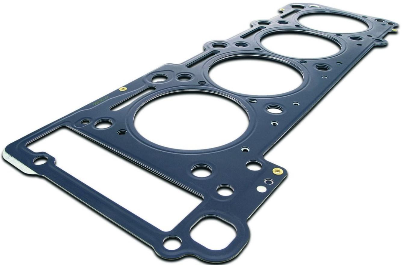
Neben der Aufgabe, die verschiedenen Medien wie Gase, Wasser und Öl im Motor voneinander und nach außen abzudichten, dienen Dichtungen außerdem als Kraftübertragungsglied. Beispielsweise hat die Zylinderkopfdichtung zwischen dem Motorblock und dem Zylinderblock einen erheblichen Einfluss auf die Kraftverteilung innerhalb des gesamten Verspannungssystems und die dadurch verursachten Bauteilverformungen.
