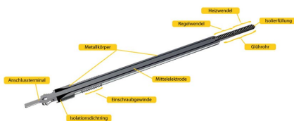
Querschnitt Metallstabglühkerzen
