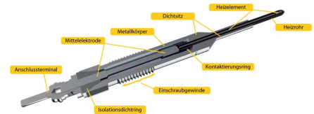
Querschnitt Keramikglühkerzen
